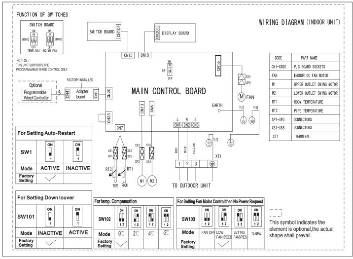
Figure 24. MFMA012S4-\*P Unit Wiring Diagram
