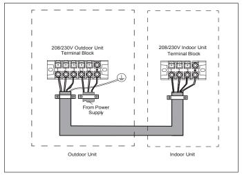
Figure 23. Single-Zone Wiring 12K
