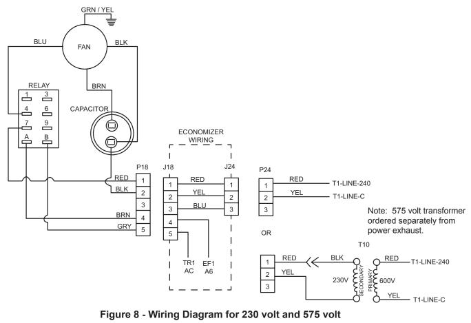
Figure 8 - Wiring Diagram for 230 volt and 575 volt 4
