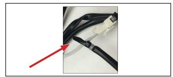
Figure 29. Sensor Thermistor
