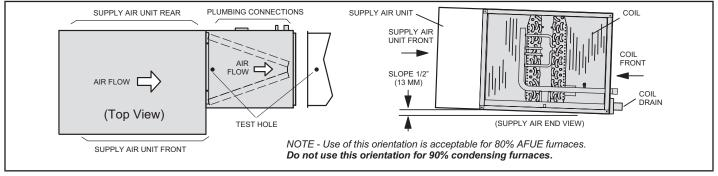
FIGURE 4. Right-Hand Air Discharge
