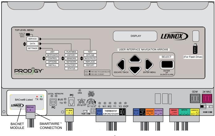
Figure 1. M2 BACnet<sup>®</sup> Module (BP1)
