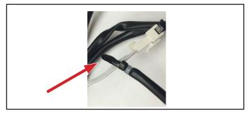
Figure 23. Sensor Thermistor
